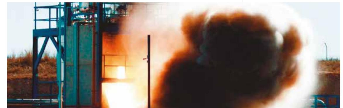
Ensayo del motor cohete de combustible líquido desarrollado por PLD Space en las instalaciones que la empresa tiene en el aeropuerto de Teruel
